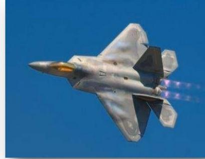
Les Ailes « Trapézoïdales »
