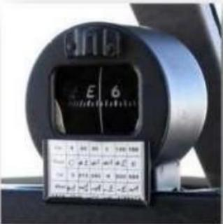
Une graduation de 0 à 360 degrés tourne devant une ligne de foi figurant l'axe de l'avion, ce qui permet au pilote de savoir le cap magnétique suivi.
